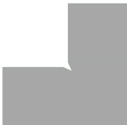
In der Abwicklung wird ein V-förmiger Ausschnitt gesetzt. Die Freisparung zeichnet sich durch eine Mindestfreistellung aus, die einen nachfolgenden Schweißvorgang zum schließen der Ecke zulässt.
