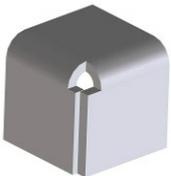
Stoß mit halber Materialstärke, wenig Schleifarbeit nach dem Schweißen
