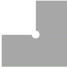
In der Abwicklung wird ein Rundstempel im Schnittpunkt der Biegelinen gesetzt.
